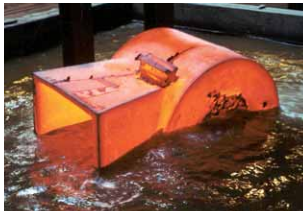
Heat treatment of hinge point voor CSO Deep Blue.
